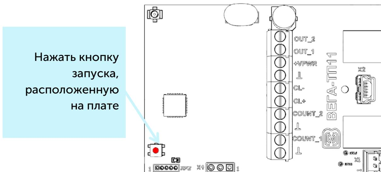
**2. Способ OTAA.** После нажатия на кнопку запуска, устройство осуществит три попытки присоединения к сети в заданном при настройке частотном плане. При получении подтверждения активации в сети LoRaWAN, устройство подаст сигнал индикатором (свечение в течение 5 секунд) и перейдет в режим «Активный». Если все
